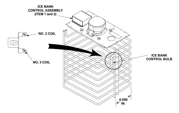
FIGURE 1. ICE BANK CONTROL PROBE LOCATION
